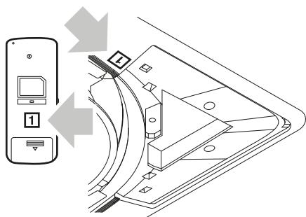
**POZNÁMKA** Nastavte číslo jednotky prijímača a bezdrôtového diaľkového ovládača tak, aby boli rovnaké. Ak sa nastavenia odlišujú, signál z diaľkového ovládača nie je možné vyslať.
